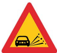
(K-13) Επικίνδυνη εκτίναξη χαλίκων (ασύνδετο αμμοχάλικο).
