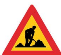
(K-20) Κίνδυνος λόγω εκτελουμένων εργασιών στην οδό.
